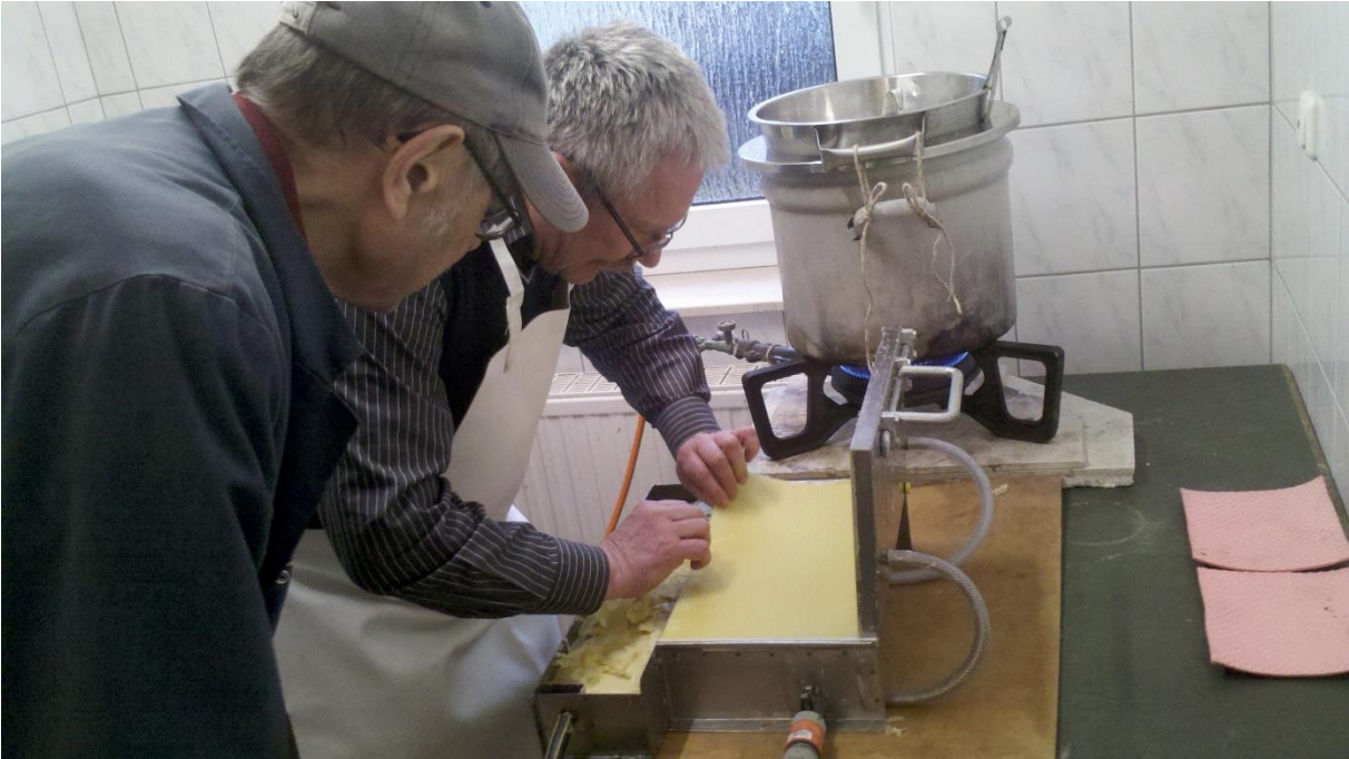
(Schritt 3: ... die fertige Mittelwand aus der Presse holen)
